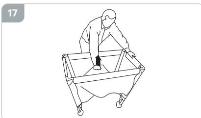
Presione los botones de bloqueo y empuje hacia abajo para destrabar los laterales horizontales largos.
