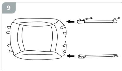
Pase las cuatros correas del cambiador por los orificios del lateral de plástico. Repita el mismo paso para el lado contrario (**fig.10**).
