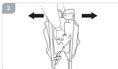
Repita el proceso con los laterales más largos. Es muy importante que **NO BAJE EL CENTRO** hasta que los laterales estén completamente desplegados y bloqueados (**fig.3**).
